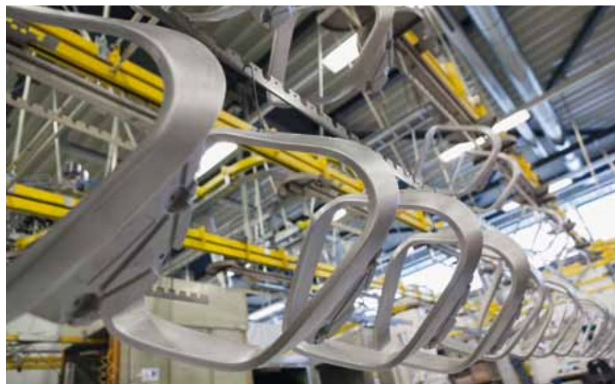
Armlehnen für Stühle aus Aluminiumdruckguss werden hochglanz Schwarz beschichtet. Als Systemlieferant Guss beschaffen wir auch den Guss.
