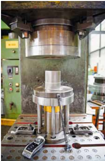
Chromstahl Behälter für die Gastro-Industrie wird im Stülpverfahren aus Blech im kalten Zustand gefertigt. Foto: Stefan Kubli
