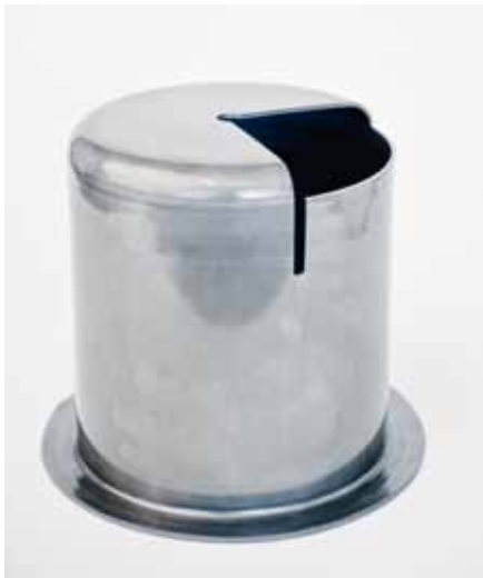
Bremszylinder-Topf für Bahnwagons mit einem Durchmesser von 254 mm und einer Höhe von 286 mm wird aus 4 mm dickem Stahl in kaltem Zustand tiefgezogen.
